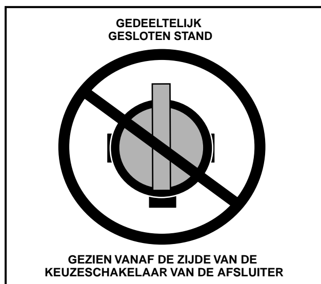
Figuur 20 Verkeerde afstelling van de brandstofafsluiter
