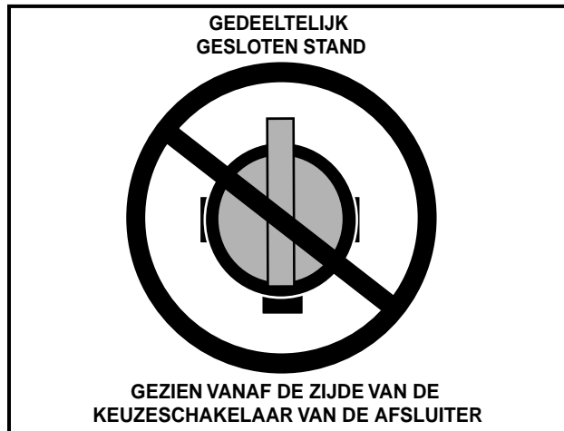
Figuur 14 Brandstofafsluiter – gedeeltelijk gesloten stand
