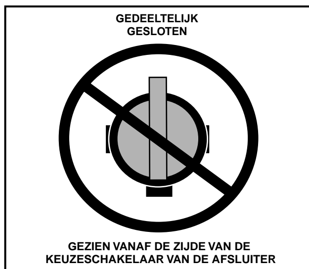
Figuur 18 Verkeerde afstelling van de brandstofafsluiter
