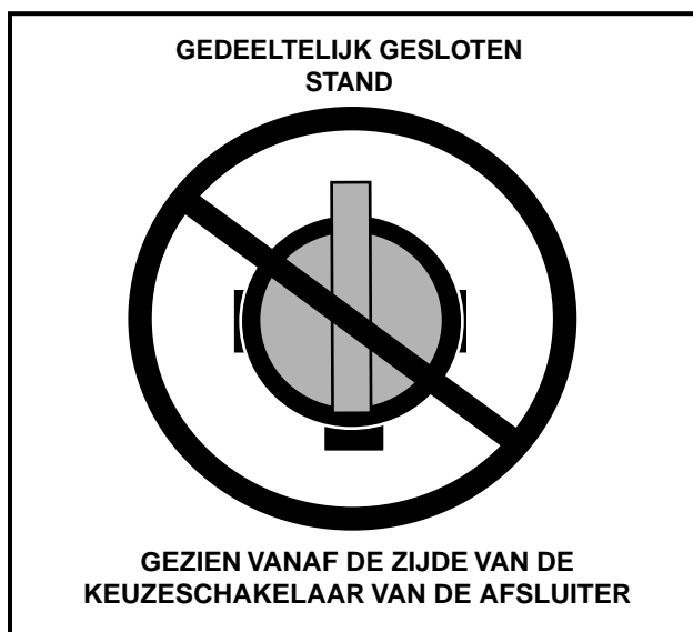
Figuur 16 Verkeerde afstelling van de brandstofafsluiter
