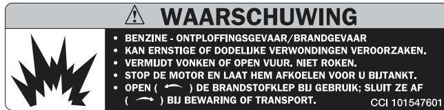
WAARSCHUWINGSSTICKER BENZINETANK (OP CHASSIS)
