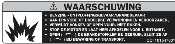
WAARSCHUWINGSSTICKER BENZINETANK (OP CHASSIS)
