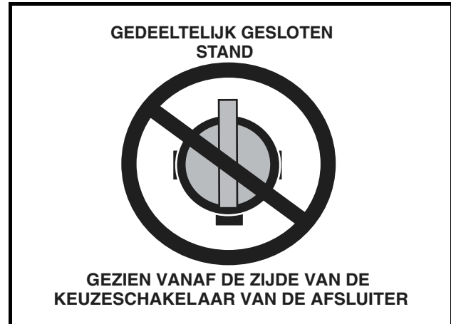
Figuur 18 Brandstofafsluiter – gedeeltelijk gesloten stand
