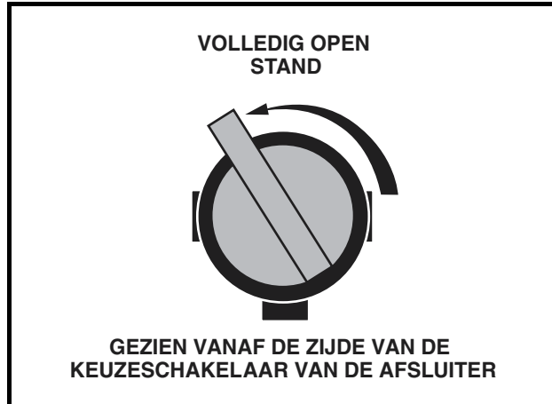
Figuur 17 Brandstofafsluiter – open stand
