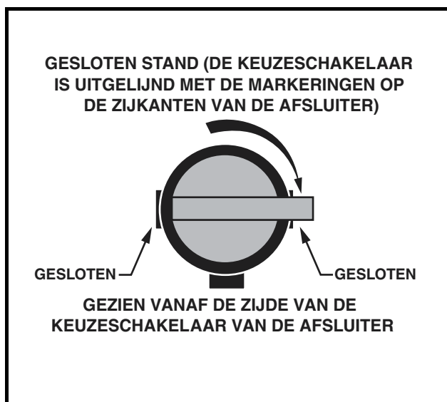
Figuur 16 Brandstofafsluiter – gesloten stand
