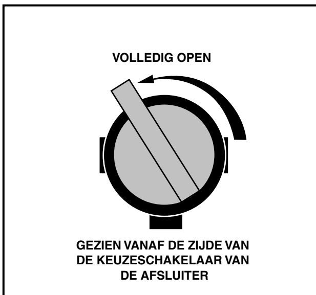
Figuur 11 Brandstofafsluiter – open
