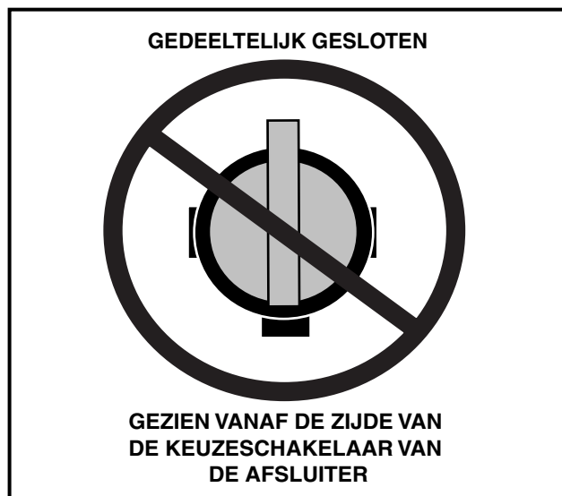
Figuur 12 Verkeerde afstelling van de brandstofafsluiter
